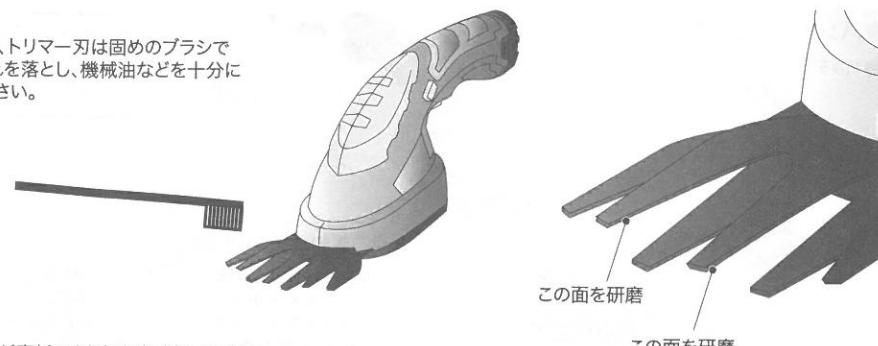
刃のエッジが摩耗により切れなくなった時は、市販のダイヤモンドやすりなどで研磨して下さい。その際、刃の擦り合わせ面が丸くならないように注意して下さい。
