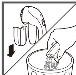
調節カバーを外しダストボックスを下に引き抜き、中身を廃棄してください。
