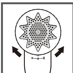
ダイヤルを回して、外刃と生地との距離を調節するカバーです。
