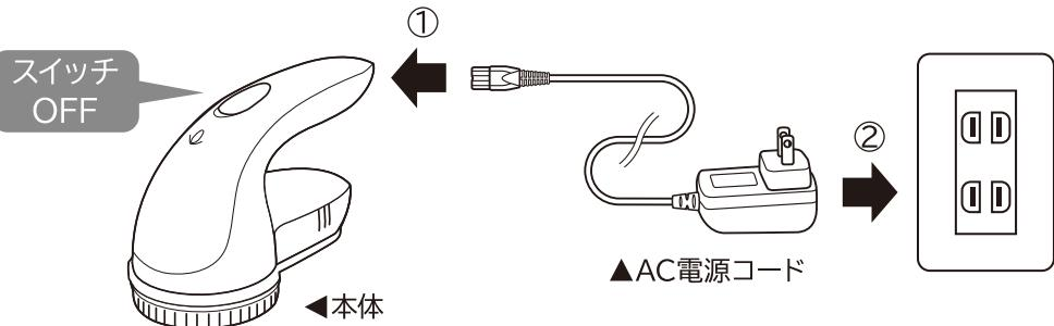
①スイッチが「OFF」になっていることを確認し、本品専用のAC電源コードを本体にしっかりと差し込みます。
